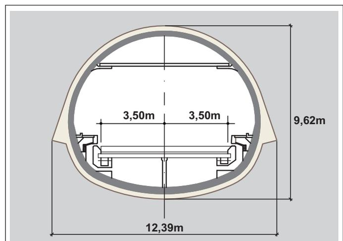
Seção Típica do Túnel
